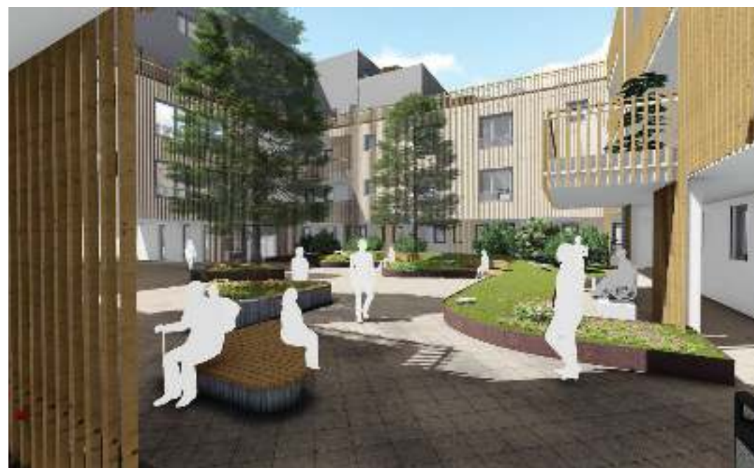
Senkrechte Holzlamellen verkleiden zum Teil die Fassaden und Laubengänge zum Innenhof.
